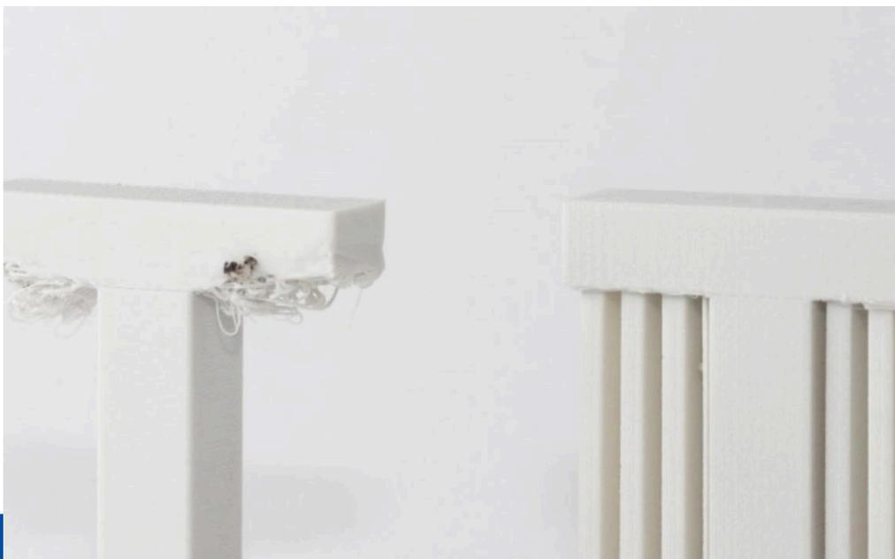
La figura de arriba muestra que la letra T se imprimió con material de soporte. La razón es que tiene un ángulo vertical de 90 grados, lo que significa que necesitarás imprimir estructuras de soporte. De lo contrario, el resultado final será desastroso.
